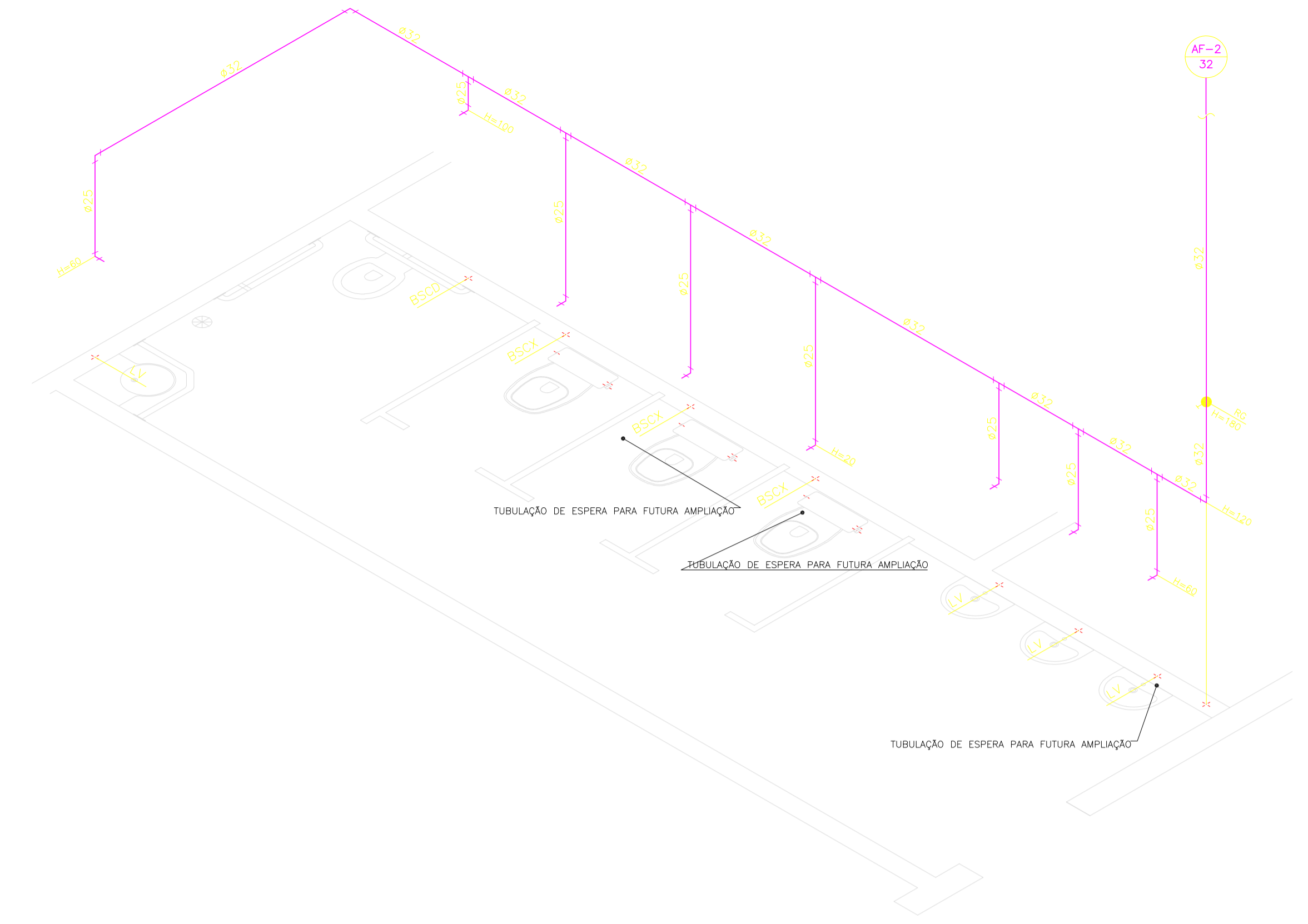
2 ISOMÉTRICA DE ÁGUA FRIA - BANHEIRO FEMININO ESCALA: 1:25
